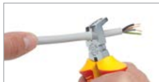
Coupez le câble à l'aide de la pince latérale
