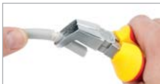
Pliez légèrement l'extrémité du câble jusqu'à ce que le point de séparation se casse, puis retirez le morceau de gaine
