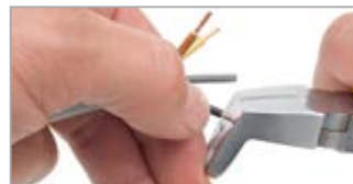
Retirez l'isolation des conducteurs individuels avec les trous d'extraction
