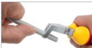
Coupez avec soin dans la gaine avec les lames jusqu'à ce que la butée repose contre la gaine. Faites ensuite pivoter la pince à mi-chemin autour du câble
