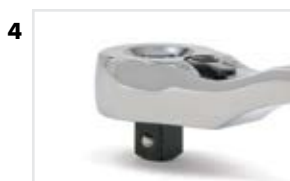
4 Lever de changement de direction situé à la base de la tête du cliquet et protégé pour éviter un changement de direction non souhaité.
