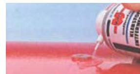
2. Vaporiser le Dissolvant pour Adhésif directement dans l'espace entre l'adhésif et la surface et permettre un bref temps d'action.
