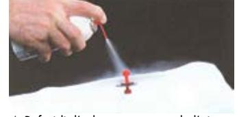
4. Refroidir l'adaptateur avec de l'air comprimé ou le spray refroidisseur.
