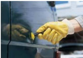
5. Chauffer l'adaptateur avec un ventilateur d'air chaud à une température de 150 °C (302 °F), et avec l'aide du manche enlever l'adaptateur d'un geste oblique.
