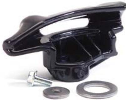
La Tête de Canard monte et démonte le pneu de la roue. La tête de montage/ de démontage en plastique permet un contact plus doux avec la jante durant le montage et l'enlèvement des pneus, contribuant ainsi à éviter les égratignures et les dommages sur les jantes dispendieuses.
